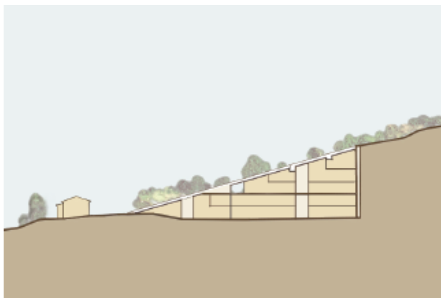
4. SEZIONE SCHEMATICA. AL PIANO INFERIORE GLI AMBIENTI PER IL TRATTAMENTO DEI MATERIALI IN ARRIVO. AI PIANI INTERMEDI I DEPOSITI DI STOCCAGGIO, LABORATORI DI ANALISI E RESTAURO. IN ALTO GLI AMBIENTI DI STUDIO (disegno R.D.R.)
