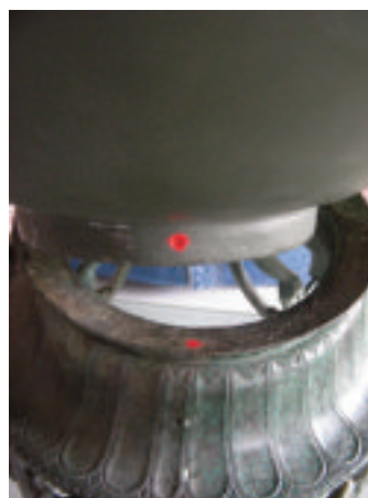
49. SEGNI DI RIFERIMENTO PER IL POSIZIONAMENTO DEL CRATERE SUL TRIPODE
