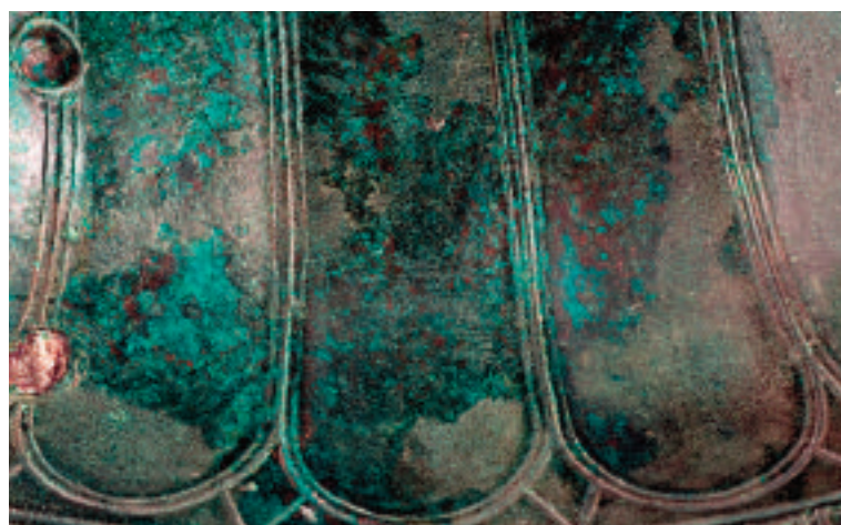
24. PARTICOLARE DEL PIEDE. CORROSIONE INTERGRANULARE
