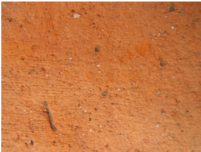
Fig. 5. Corpo ceramico di una tegola picena (analisi macroscopica).
