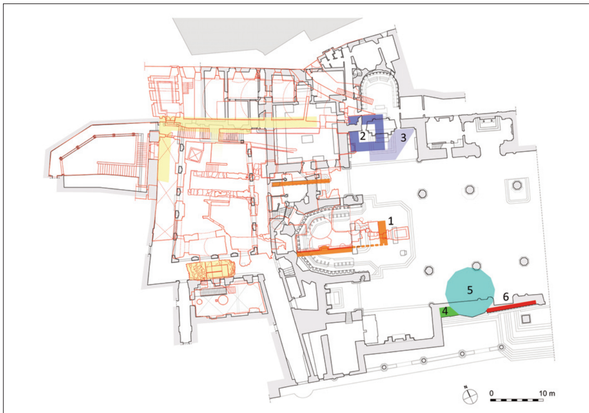
14. PIANTA AL LIVELLO DELLA CATTEDRALE E DEL CORTILE SUPERIORE; DALLA SOVRAPPOSIZIONE CON GLI AMBIENTI IPOGEI SI EVINCE CHE I MURI (IN GIALLO) DEL TERRAZZAMENTO ETRUSCO HANNO DETERMINATO POSIZIONE E CONFIGURAZIONE TRAPEZOIDALE DEL CORTILE SUPERIORE; SONO INDICATI INOLTRE ALCUNI RESTI APPARTENENTI AL COMPLESSO DELLA CATTEDRALE PREESISTENTE ALL'ATTUALE: LE MURATURE A BOZZETTE, DI CUI UNA DOTATA DI LESENE, CHE POTEVANO DELINEARE UN UNICO EDIFICIO (MARRONE 1); I RESTI DI UN ARNONE DI UN PRONAO (VERDE 4), DI UN CAMPANILE DODECAGONALE (CELESTE 5) E DELLA CAPPELLA DI SANT'ERCOLANO (ROSSO 6); SOTTO IL BRACCIO NORD DEL TRANSETTO, LA BASE DI UNA TORRE (VIOLA 2) CON UN TRATTO DI STRADA ADIACENTE (VIOLA CHIARO 3) (elaborazione Autori)
