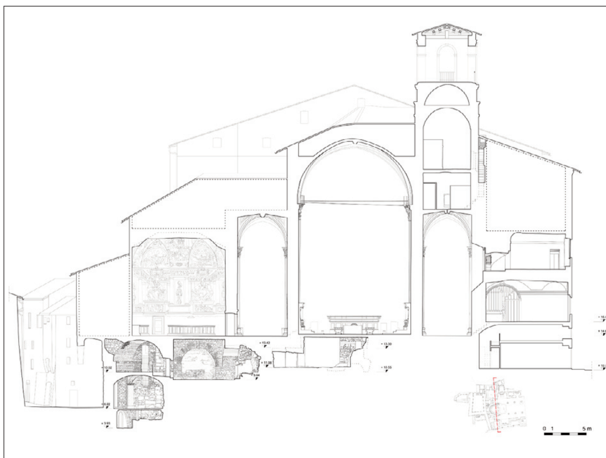
17. SEZIONE DEL COMPLESSO CHE INTERCETTA IL PRESBITERIO, LE CAPPELLE LATERALI DELL'ABSIDE E ALCUNI AMBIENTI IPOGEI, IN RELAZIONE A VIA DELLE CANTINE (A SINISTRA) E A PIAZZA IV NOVEMBRE (A DESTRA) (elaborazione Autori)
