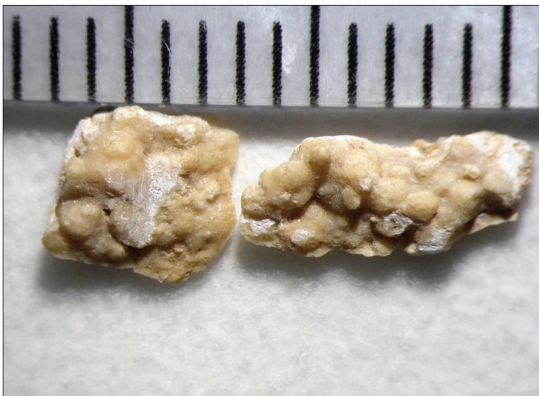
7. STEREO-MICROSCOPIO, LUCE RIFLESSA. L'INTERVALLO TRA LE TACCHE DEL RIFERIMENTO MISURA MM 1,0. L'IMMAGINE ILLUSTRA LE DUE SCAGLIE COMPRESSE NEL PRELIEVO N.3 RIPRESE DALLA FACCIA ESTERNA: EVIDENTE LA STRUTTURA "A GRAPPOLO" TIPICA DELLE INCROSTAZIONI-CONCREZIONI (foto Autore)
