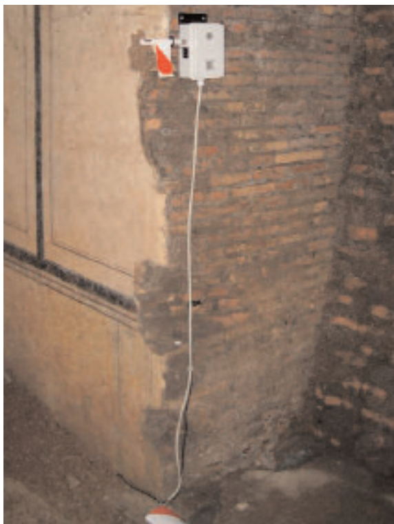
25. ROMA. PIRAMIDE DI CAIO CESTIO. INTERNO. TRASDUTTORE DI CONCENTRAZIONE DI ANIDRIDE CARBONICA
