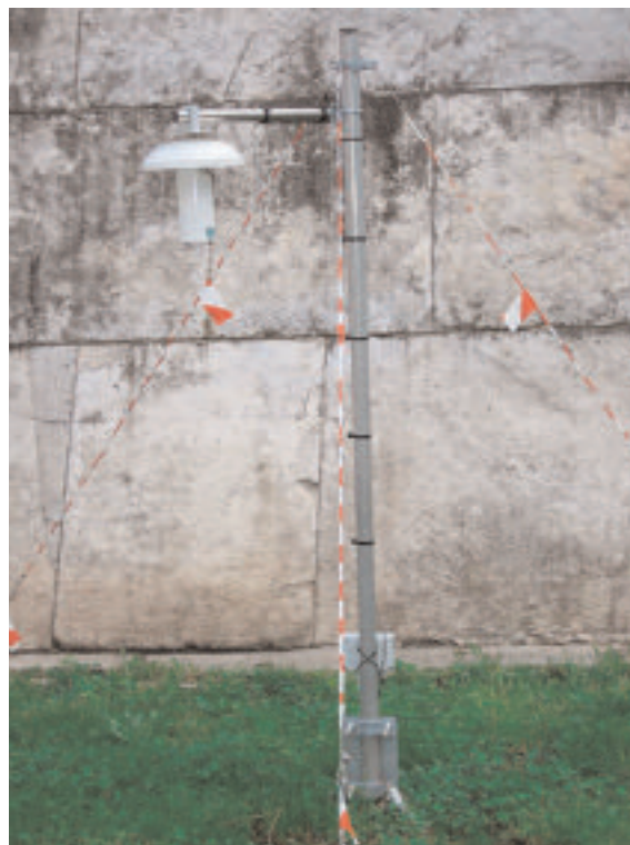
26. ROMA. PIRAMIDE DI CAIO CESTIO. ESTERNO. TRASDUTTORE DI CONCENTRAZIONE DI CONTENUTO D'ACQUA DEL TERRENO
