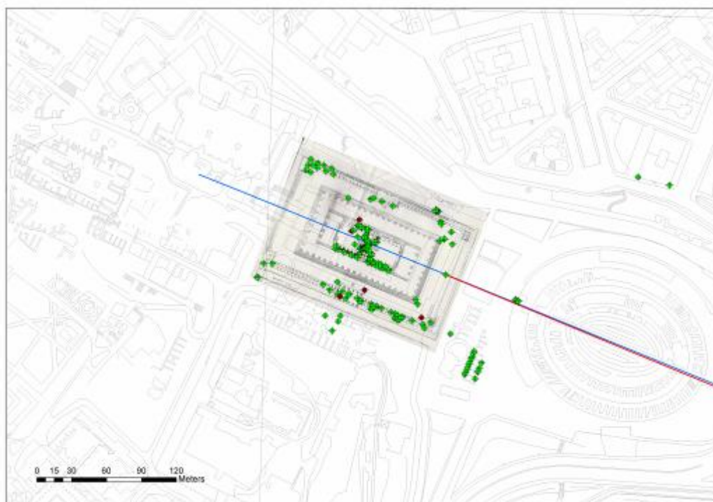
Fig. 3. L'orientamento del Colosseo (rosso) e del basamento del Tempio di Venere e Roma (blu). In verde i punti rilevati; in rosso le stazioni.
